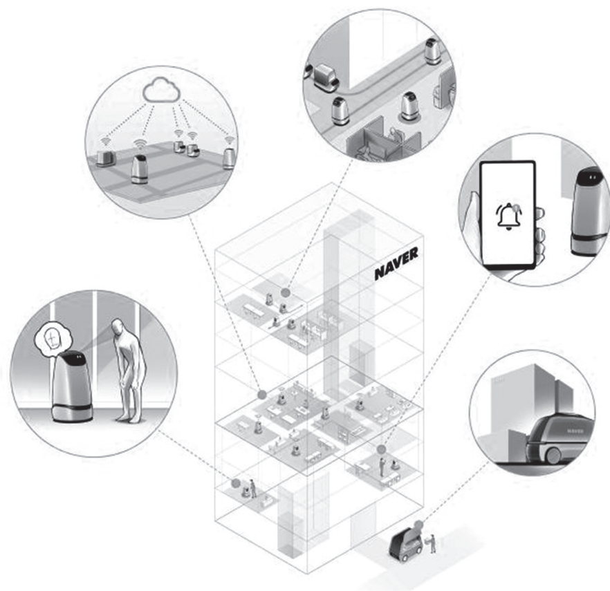
图 13 城市机器人利用垂直空间示意；Naver Robot-friendly Building
