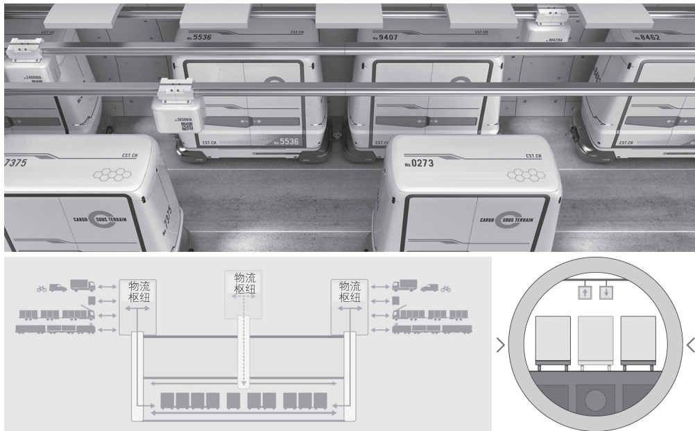
图 12 城市机器人利用地下空间示意：Cargo Sous Terrain
